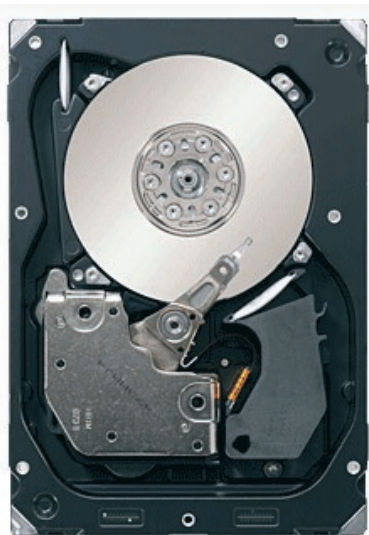
Il classico disco del computer con testina di lettura/scrittura.
